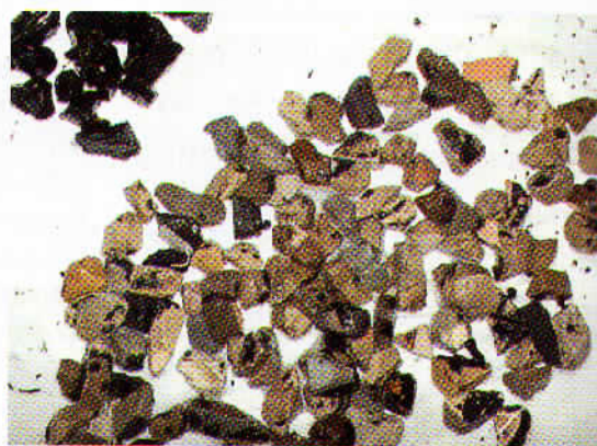
Figura 1 - Risultati della prova di affinità ai leganti bituminosi su campione non trattato; nell'angolo in alto a sinistra, particolare del pietrisco prima del test
