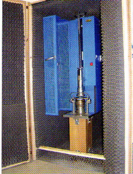
Figure 3 e 4 - Costipatore meccanico per il confezionamento di provini Marshall ed esecuzione della prova con pressa multivelocità
