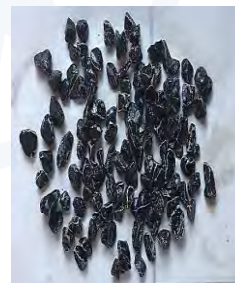
Bitume + 0,4% STARDOPE WARM- MIX
