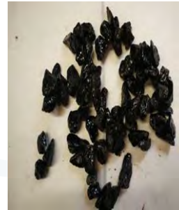
Bitume + 0,4% STARDOPE WARM-MIX
