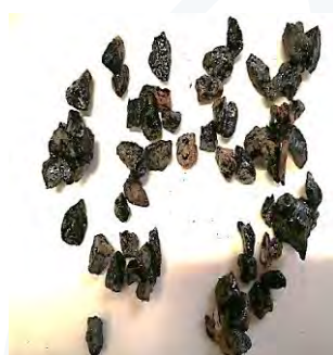
Bitume tal quale
