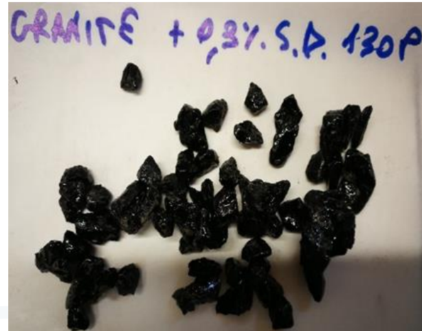
Figura 4b. Risultati Boiling Water Stripping Test inerti granitici: a sinistra bitume senza additivo, a destra bitume con l'aggiunta dello 0,3% di StarDope® 130 P.
