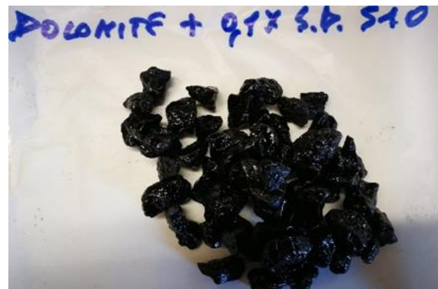
Figura 6c. Risultati Boiling Water Stripping Test inerti dolomitici: a sinistra bitume senza additivo, a destra bitume con l'aggiunta dello 0,1% di StarDope® 510.
