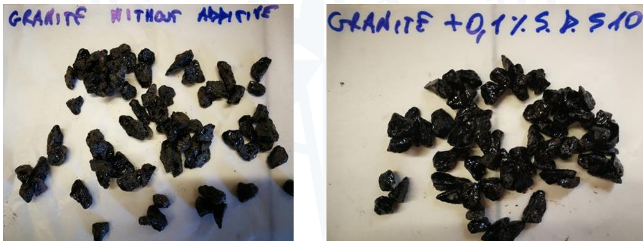
Figura 6b. Risultati Boiling Water Stripping Test inerti granitici: a sinistra bitume senza additivo, a destra bitume con l'aggiunta dello 0,1% di StarDope® 510.
