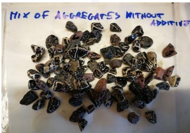
Figura 6h. Risultati Rolling Bottle Test mix inerti: a sinistra bitume senza additivo, a destra bitume con l'aggiunta di 0,1 % di StarDope® 510.
