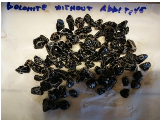
Figura 6g. Risultati Rolling Bottle Test inerti dolomitici: a sinistra bitume senza additivo, a destra bitume con l'aggiunta di 0,1 % di StarDope® 510.
