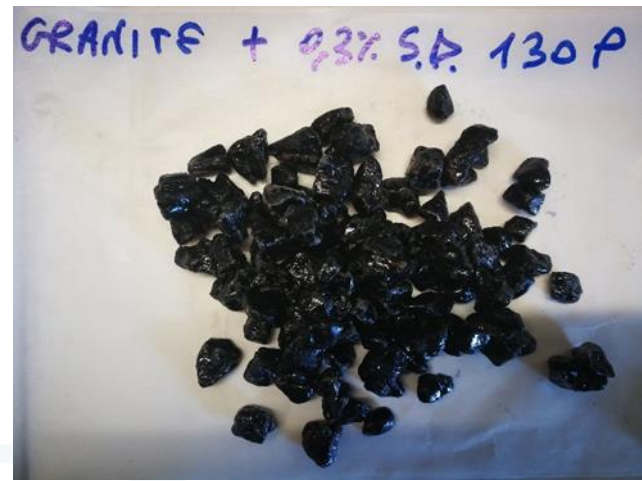
Figura 4f. Risultati Rolling Bottle Test inerti granitici: a sinistra bitume senza additivo, a destra bitume con l'aggiunta dello 0,3% di StarDope® 130 P.
