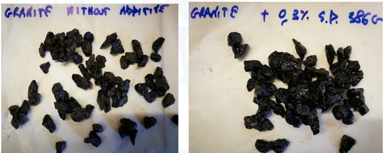
Figura 5b. Risultati Boiling water stripping Test inerti granitici: a sinistra bitume senza additivo, a destra bitume con l'aggiunta dello 0,3% di StarDope® 386 G.
