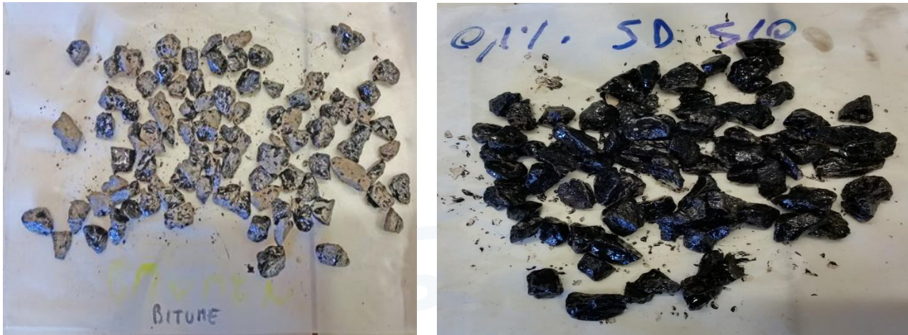
Figura 6a. Risultati Boiling Water Stripping Test inerti basaltici: a sinistra bitume senza additivo, a destra bitume con l'aggiunta dello 0,1% di StarDope® 510.
