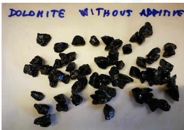
Figura 4c. Risultati Boiling Water Stripping Test inerti dolomitici: a sinistra bitume senza additivo, a destra bitume con l'aggiunta dello 0,3% di StarDope® 130 P.
