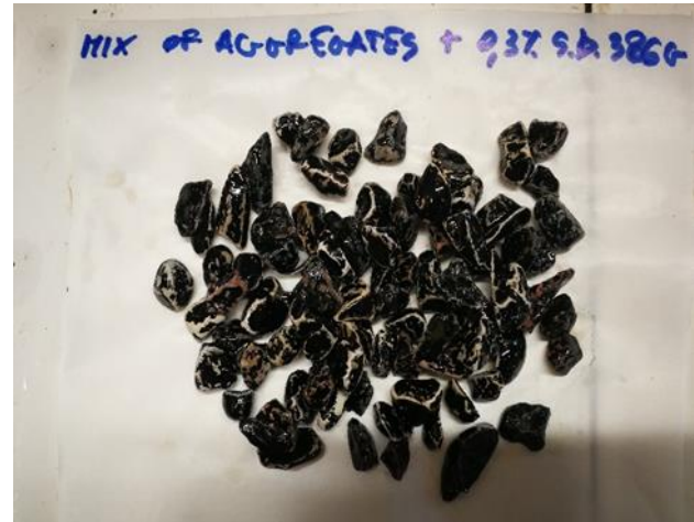
Figura 5h. Risultati Rolling Bottle Test mix di inerti: a sinistra bitume senza additivo, a destra bitume con l'aggiunta dello 0,3% di StarDope® 386 G.
