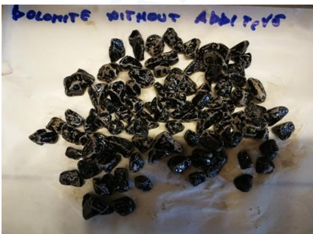
Figura 5g. Risultati Rolling Bottle Test inerti dolomitici: a sinistra bitume senza additivo, a destra bitume con l'aggiunta dello 0,3% di StarDope® 386 G.
