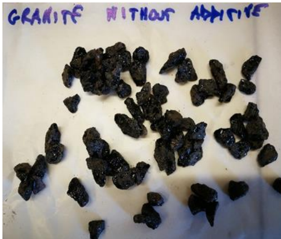
Figura 4b. Risultati Boiling Water Stripping Test inerti granitici: a sinistra bitume senza additivo, a destra bitume con l'aggiunta dello 0,3% di StarDope® 130 P.
