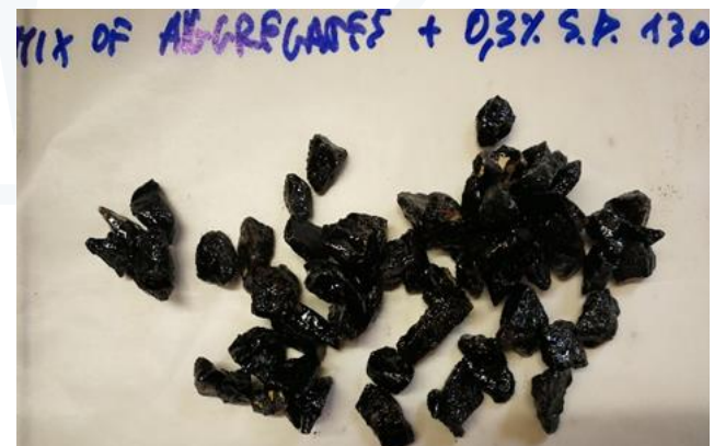
Figura 4d. Risultati Boiling Water Stripping Test mix di inerti: a sinistra bitume senza additivo, a destra bitume con l'aggiunta dello 0,3% di StarDope® 130 P.
