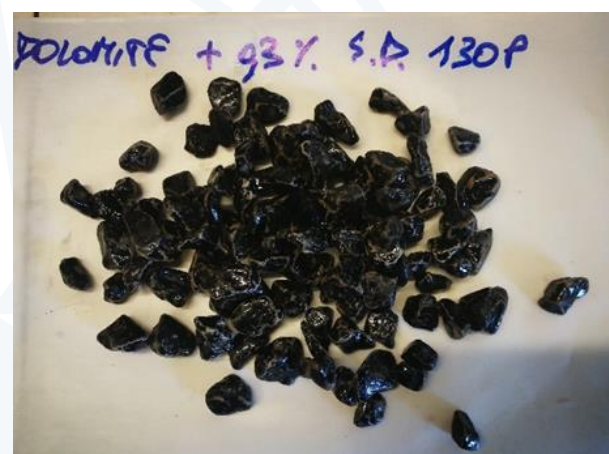
Figura 4g. Risultati Rolling Bottle Test inerti dolomitici: a sinistra bitume senza additivo, a destra bitume con l'aggiunta dello 0,3% di StarDope® 130 P.
