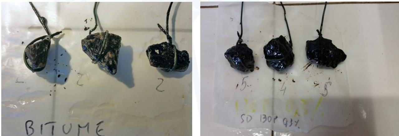
Figura 4i. Risultati Test inerti granitici: a sinistra bitume senza additivo, a destra bitume con l'aggiunta dello 0,3% di StarDope® 130 P.
