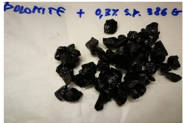
Figura 5c. Risultati Boiling water stripping Test inerti dolomitici: a sinistra bitume senza additivo, a destra bitume con l'aggiunta dello 0,3% di StarDope® 386 G.
