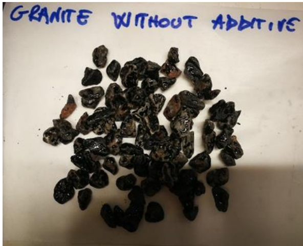
Figura 5f. Risultati Rolling Bottle Test inerti granitici: a sinistra bitume senza additivo, a destra bitume con l'aggiunta dello 0,3% di StarDope® 386 G.
