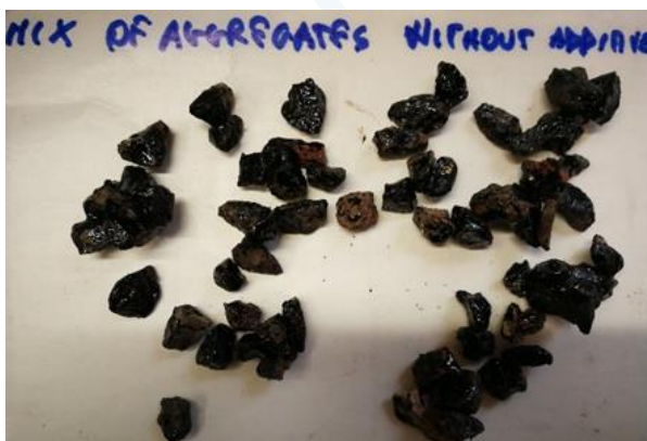
Figura 4d. Risultati Boiling Water Stripping Test mix di inerti: a sinistra bitume senza additivo, a destra bitume con l'aggiunta dello 0,3% di StarDope® 130 P.
