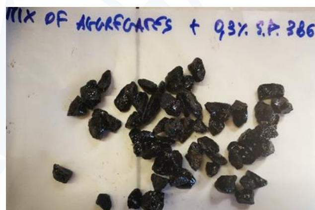
Figura 5d. Risultati Boiling water stripping Test mix di inerti: a sinistra bitume senza additivo, a destra bitume con l'aggiunta dello 0,3% di StarDope® 386 G.
