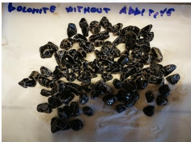
Figura 4g. Risultati Rolling Bottle Test inerti dolomitici: a sinistra bitume senza additivo, a destra bitume con l'aggiunta dello 0,3% di StarDope® 130 P.
