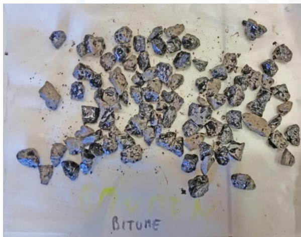
Figura 4a. Risultati Boiling Water Stripping Test inerti basaltici: a sinistra bitume senza additivo, a destra bitume con l'aggiunta dello 0,3% di StarDope® 130 P.
