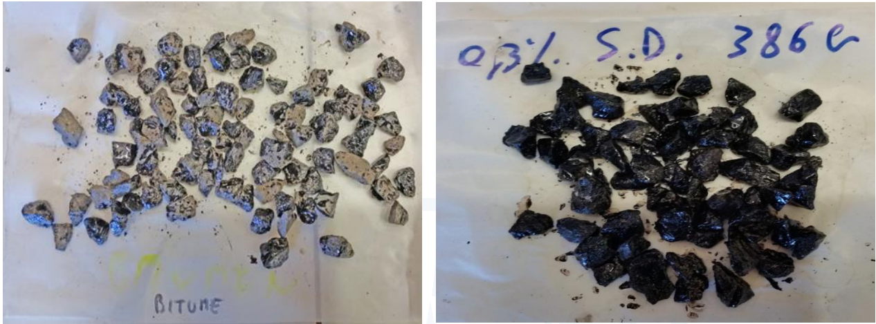
Figura 5a. Risultati Boiling water stripping Test inerti basaltici: a sinistra bitume senza additivo, a destra bitume con l'aggiunta dello 0,3% di StarDope® 386 G.
