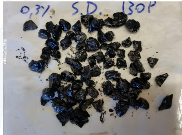
Figura 4a. Risultati Boiling Water Stripping Test inerti basaltici: a sinistra bitume senza additivo, a destra bitume con l'aggiunta dello 0,3% di StarDope® 130 P.
