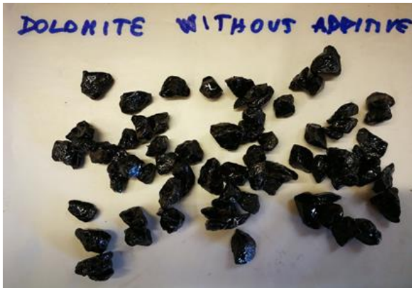
Figura 6c. Risultati Boiling Water Stripping Test inerti dolomitici: a sinistra bitume senza additivo, a destra bitume con l'aggiunta dello 0,1% di StarDope® 510.
