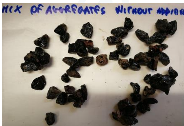
Figura 5d. Risultati Boiling water stripping Test mix di inerti: a sinistra bitume senza additivo, a destra bitume con l'aggiunta dello 0,3% di StarDope® 386 G.
