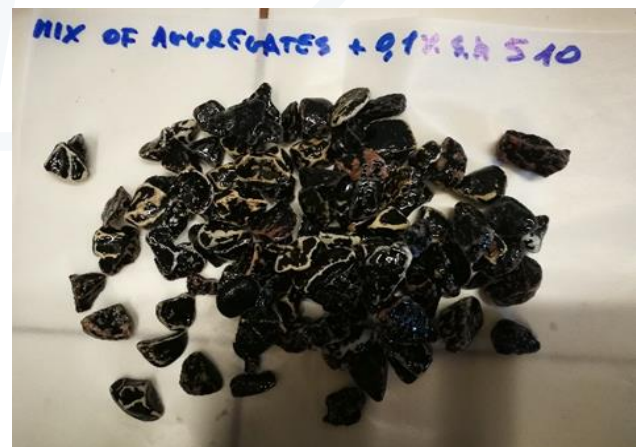
Figura 6h. Risultati Rolling Bottle Test mix inerti: a sinistra bitume senza additivo, a destra bitume con l'aggiunta di 0,1 % di StarDope® 510.
