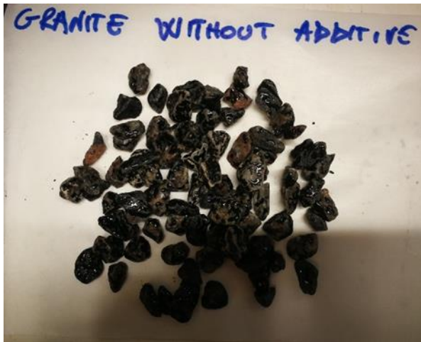
Figura 4f. Risultati Rolling Bottle Test inerti granitici: a sinistra bitume senza additivo, a destra bitume con l'aggiunta dello 0,3% di StarDope® 130 P.
