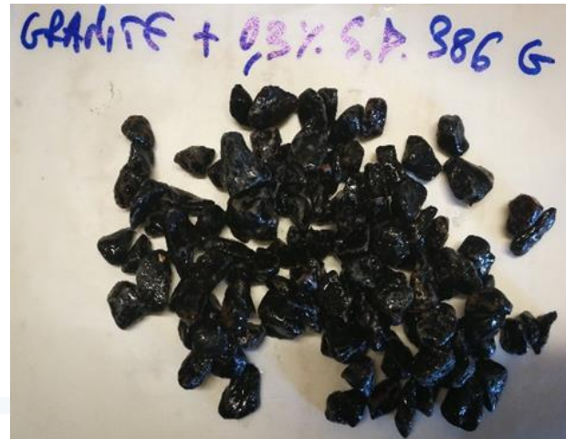
Figura 5f. Risultati Rolling Bottle Test inerti granitici: a sinistra bitume senza additivo, a destra bitume con l'aggiunta dello 0,3% di StarDope® 386 G.
