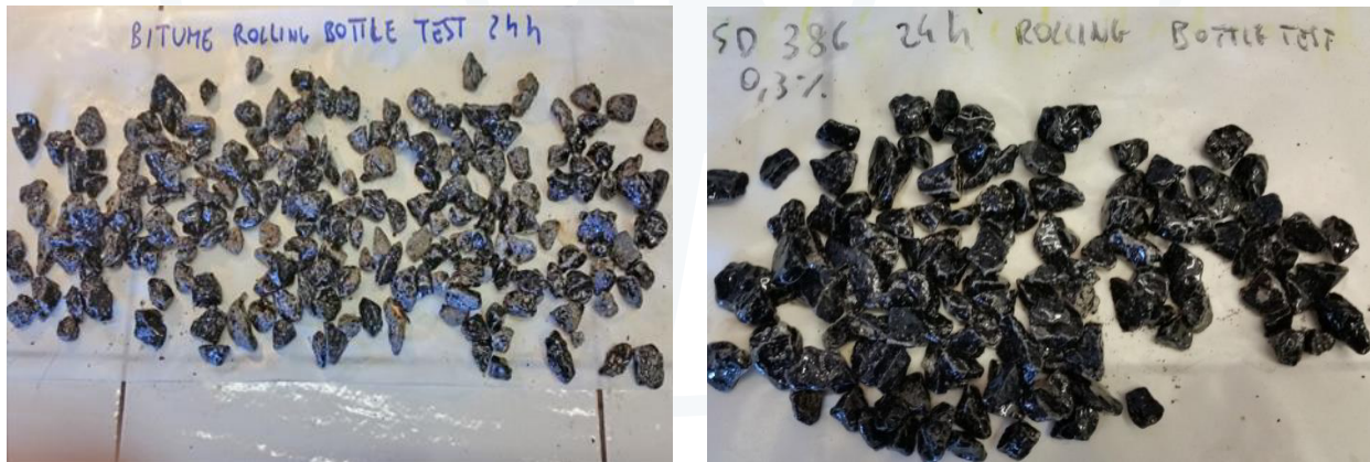
Figura 5e. Risultati Rolling Bottle Test inerti basaltici: a sinistra bitume senza additivo, a destra bitume con l'aggiunta dello 0,3% di StarDope® 386 G.
