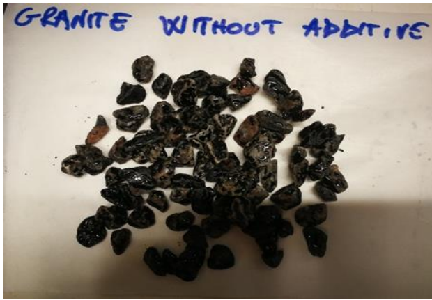
Figura 6f. Risultati Rolling Bottle Test inerti granitici: a sinistra bitume senza additivo, a destra bitume con l'aggiunta di 0,1 % di StarDope® 510.
