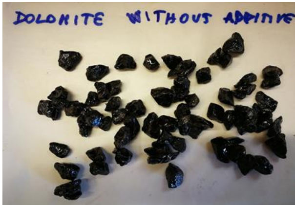
Figura 5c. Risultati Boiling water stripping Test inerti dolomitici: a sinistra bitume senza additivo, a destra bitume con l'aggiunta dello 0,3% di StarDope® 386 G.
