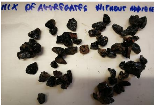
Figura 6d. Risultati Boiling Water Stripping Test mix di inerti: a sinistra bitume senza additivo, a destra bitume con l'aggiunta dello 0,1% di StarDope® 510.
