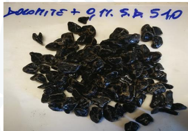
Figura 6g. Risultati Rolling Bottle Test inerti dolomitici: a sinistra bitume senza additivo, a destra bitume con l'aggiunta di 0,1 % di StarDope® 510.
